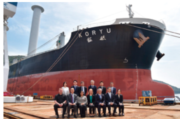
装有转子帆的矿石和硫酸运输船“KORYU号”
