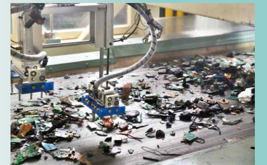
物理選別設備(日立事業所HMC製造部) IoT-AIを活用しリサイクル原料の増処理を目指す
