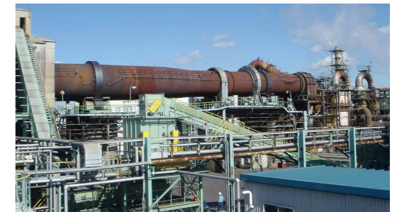
JX金属小牧ケミカル(株)のロータリーキルン式焼却炉
