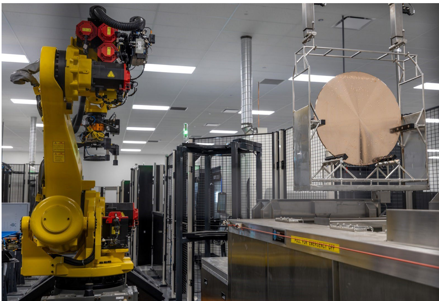
新工場の自動搬入装置で洗浄工程に運ばれたスパッタリングターゲット
