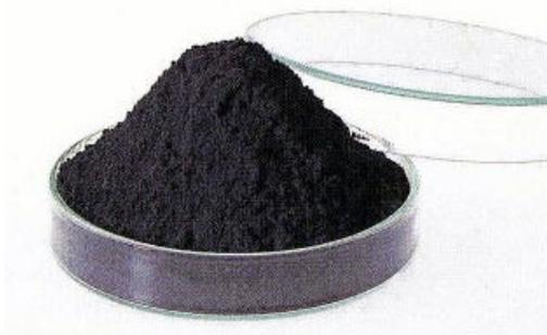
（ご参考）当社が開発した車載用リチウムイオン電池用正極材
