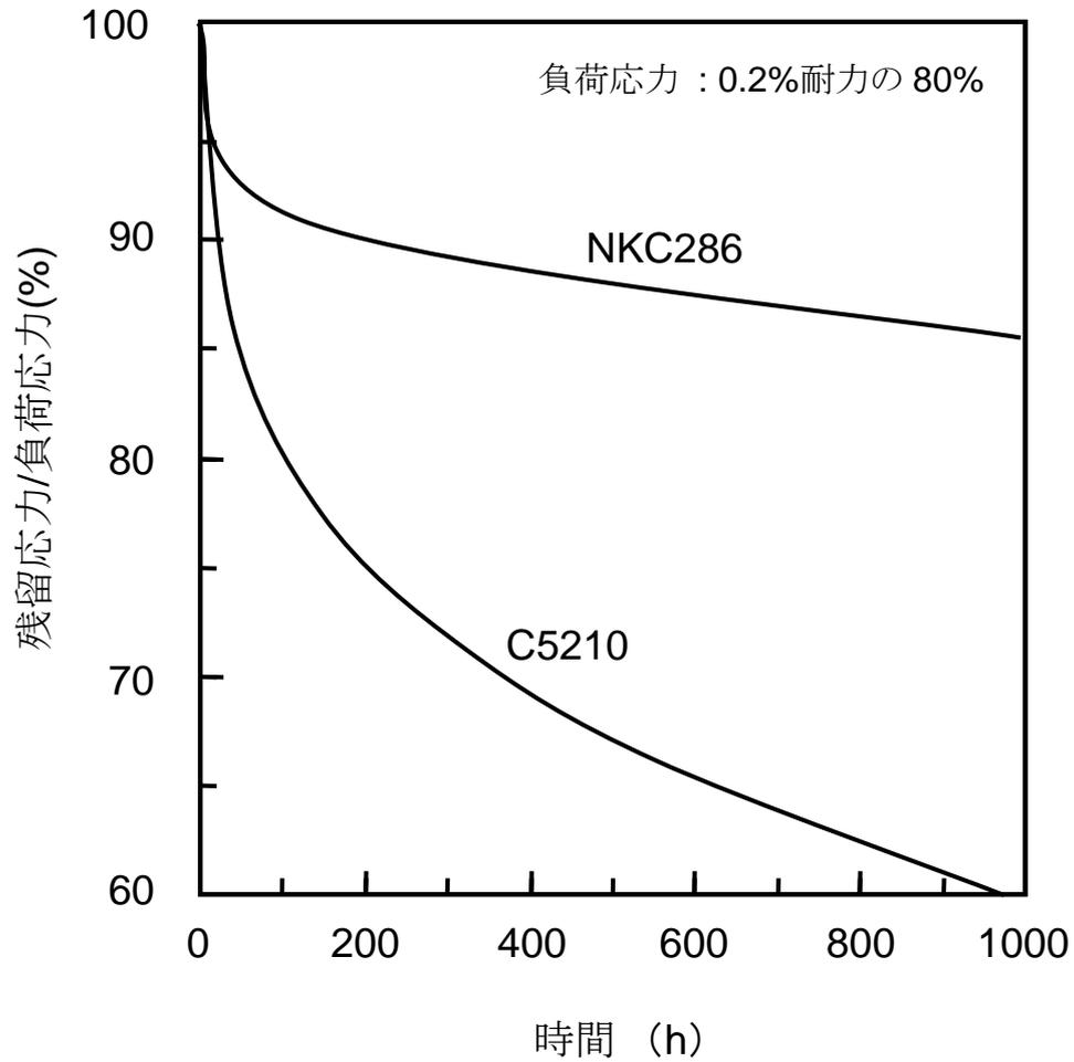
図1 NKC286 の応力緩和特性(加熱温度 150℃)
