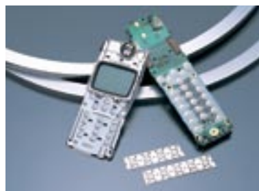
1,000万回以上のクリック耐久性(通常100万回以下)をもつ携帯電話メタルドームスイッチ(ハイパーステンレス60ミクロン箔)
