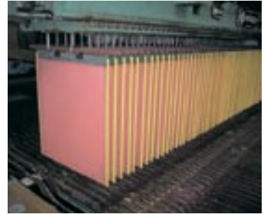
パーマネントカソード法(43ページ参照) による電気銅
