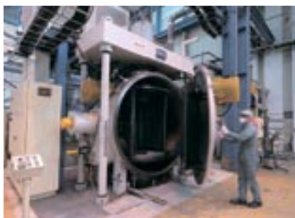
半導体用ターゲットの焼結炉（磯原工場）
