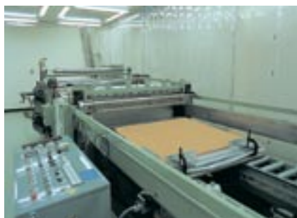
銅箔のシーティング設備（白銀工場）
