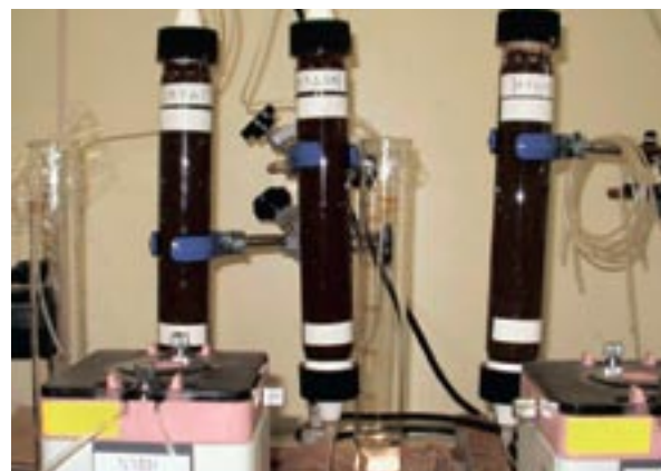
重金属汚染水の カラム 浄化試験
