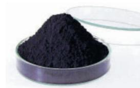
当社が独自に開発した湿式製造方法により、正極材内において全ての構成元素を同時に析出させるとともに、ナノレベルで分散性=均質性をコントロールできる製造プロセスを確立しました。これにより当社の正極材は高い均質性を実現し、当社材を採用した車載用リチウムイオン電池は、既存の正極材を採用したものに比べて20~30%の寿命の向上を可能としました。
