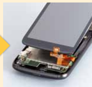
使用例：フレキシブルプリント回路基板
