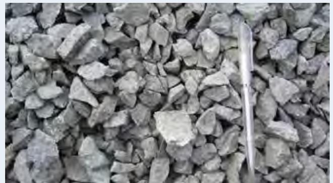
試験で使用した初生硫化銅鉱を含む粗鉱
