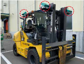
フォークリフトのカメラ設置状況
