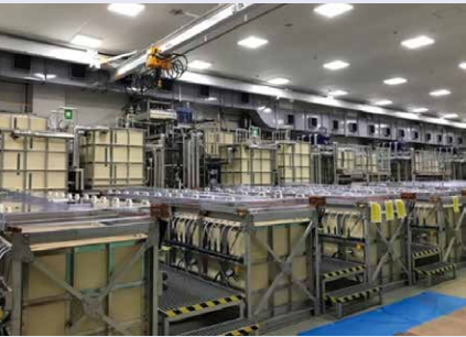
半導体用スパッタリングターゲットの設備、電解槽(当社磯原工場)
