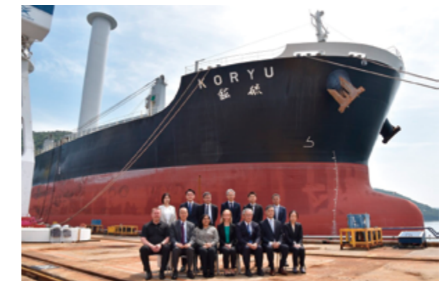
ローターセイルを設置した鉱硫船[KORYU号]
