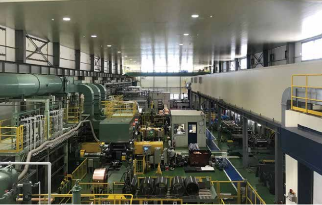
圧延銅箔および高機能銅合金条の圧延機(当社倉見工場)
