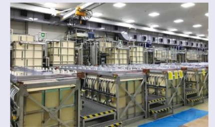
半導体用スパッタリングターゲットの設備、電解槽(磯原工場)
