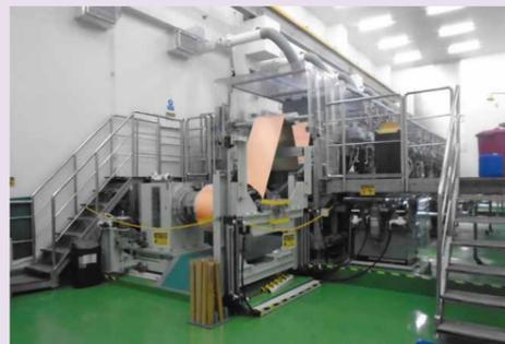
圧延銅箔表面処理の設備
