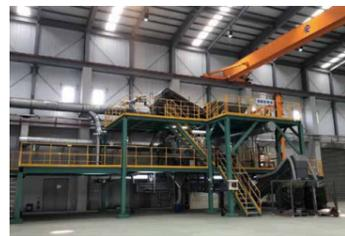
新設された破砕機および自動サンプリング設備
