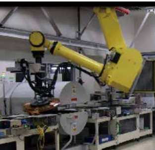
アーム型ロボットを活用した自動検査システム
