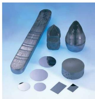
化合物半導体基板(インジウムリン、カドミウムジンクテルル)
