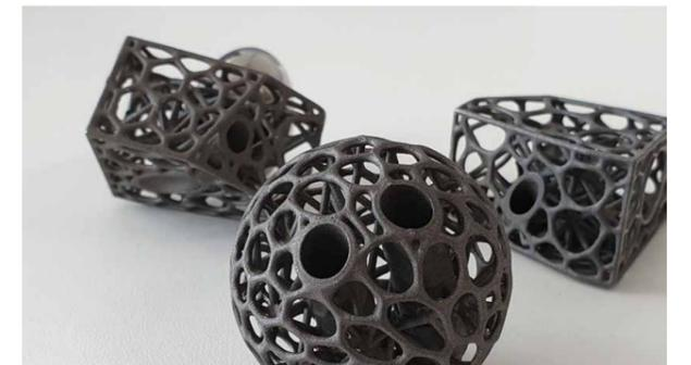
金属3Dプリンターで設計・造形された足首用のインプラント(人工骨)
