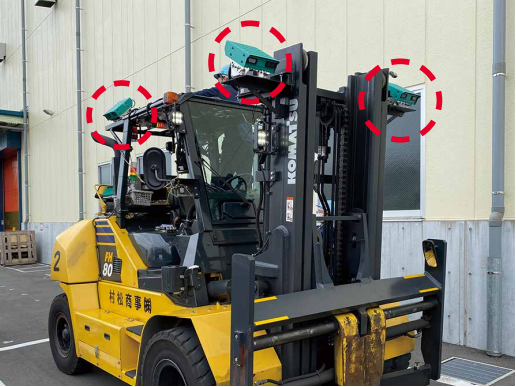
フォークリフトのカメラ設置状況
