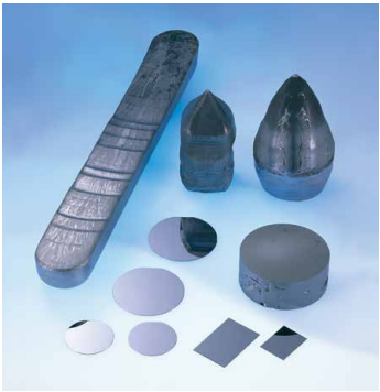
化合物半導体基板（インジウムリン、 カドミウムジnkテルル）
