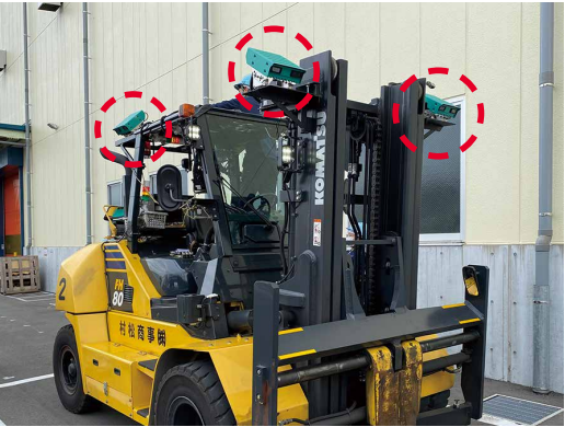
フォークリフトのカメラ設置状況
