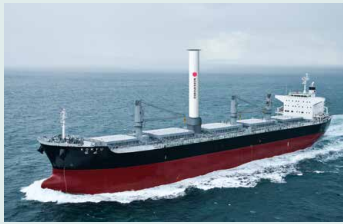
ローターセイル設置後の鉱硫船KORYU マグナス効果のイメージ
