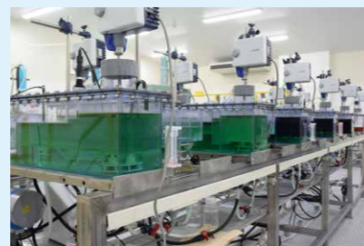
LiBリサイクルのベンチスケール設備
