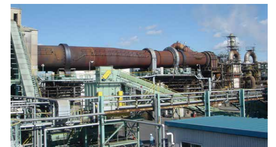
JX金属小牧ケミカル(株)のロータリーキルン式焼却炉
